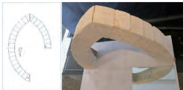
6. A la izquierda, «Arch puntegut qui pos ser mes amplia ab las matexas pesas» (J. Gelabert, Verdaderas traçes... , f. 26r). A la derecha, arco tallado en el Taller de Cantería de la ETSAM, con un espejo para mostrar la segunda posición (montaje de Alberto Calderón).
